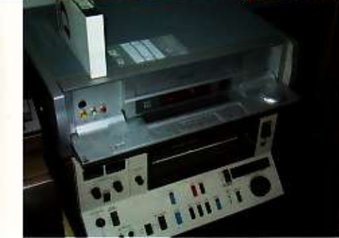
Boven de D-VHS recorder met MPEG-2, onder een U-matic recorder van Sony
